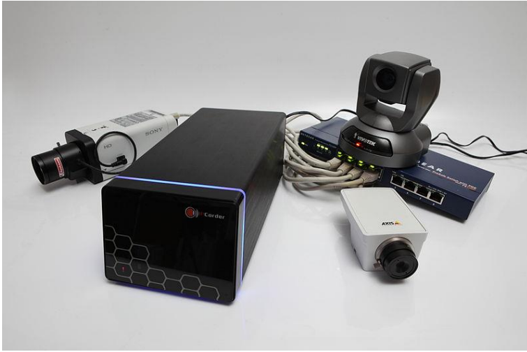
Rysunek 2. Prosty system rejestratora wideo wraz z kamerami IP [3]
